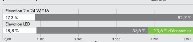
**Rénovation - remplacement d'encastrés T26 par des Elevation LED**
