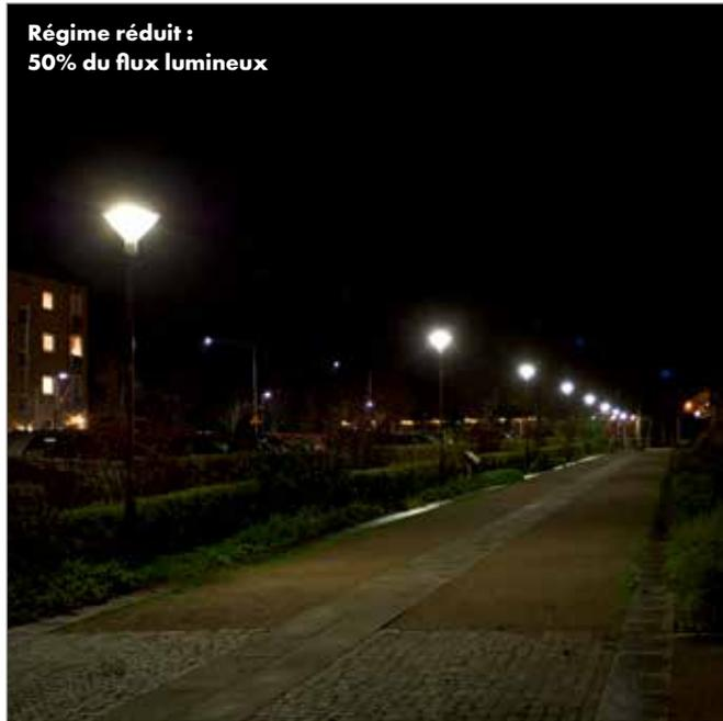
50% de réduction de la lumière, horloge intégrée avec ajustement automatique
